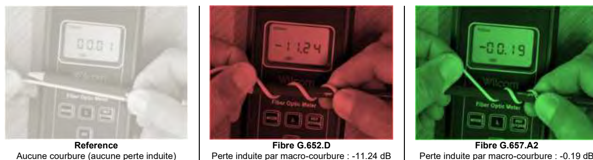
Figure 2 : Exemples de pertes induites par macro-courbures à 1550nm pour deux échantillons de fibres G.652.D et G.657.A2 en considérant deux tours complets autour d'un crayon à papier.
